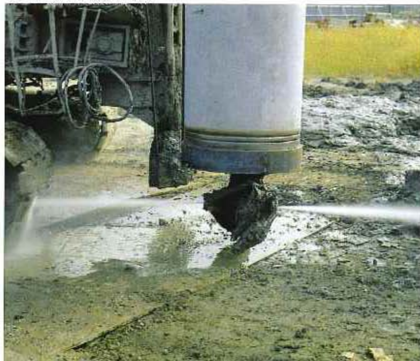
▼STJビット高圧噴射地上試験
