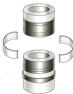
⑪PJ 油圧ジャッキを用いた機械式継手
