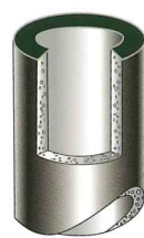
⑧SCパイル 杭周面に鋼管を使用したパイル
