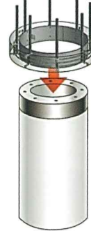
⑬キャッピングパイル工法 PCリングを杭頭に被せた工法
